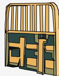
バックレストはフィンガーバーに固定（ボルト等）されている
